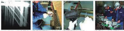
コンクリート内部の鉄筋配管位置 渦巻流探傷による熱交換チューブの試験 輪流電法による磁気探傷試験 水車ケーシングの動的応力測定
