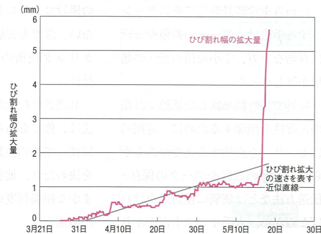
当初20mmほどだったひび割れ幅の拡大量を計測した
