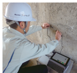
衝撃弾性波試験 (ITECS)
