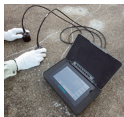
超音波法によるひび割れ測定
