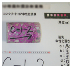
コンクリートコア中性化試験
