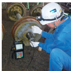
軸の超音波 探傷検査
