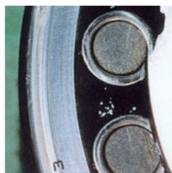
軸受のクリープによる かじりと破損
