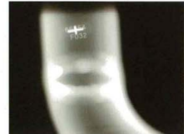
コンクリートの中の鉄筋の溶接部分の検査のために撮ったレントゲン写真。装置を選び、被爆しないよう人を遠ざけて撮影する。今回のイメージングシステムの開発がうまくいくと、装置の小型軽量化と弱い X 線の照射で撮影が可能になる。
