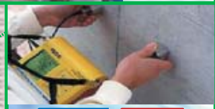
コンクリート 亀裂の深さ
